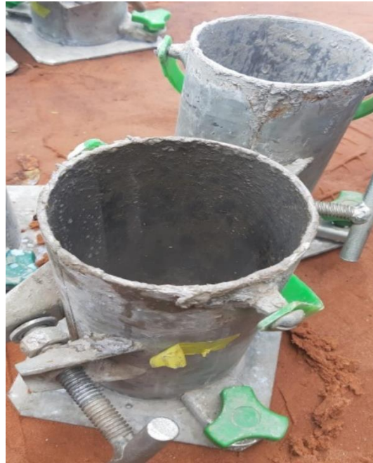
Figura 09: Corpo de Prova cilíndrico em Aço
