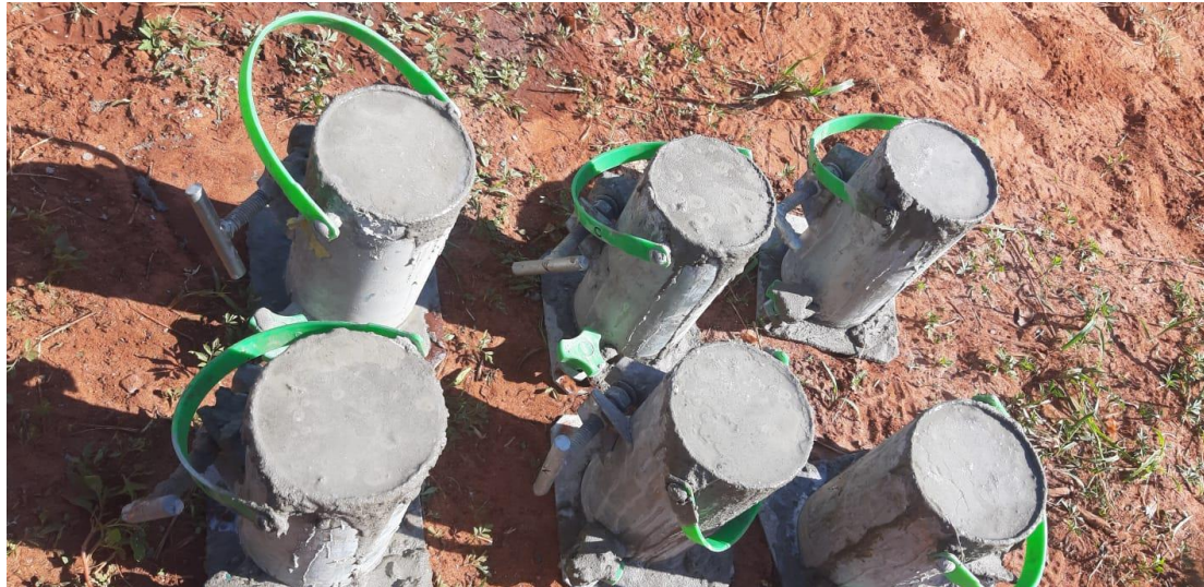
Figura 11: Corpo de Prova Concretado Totalmente
