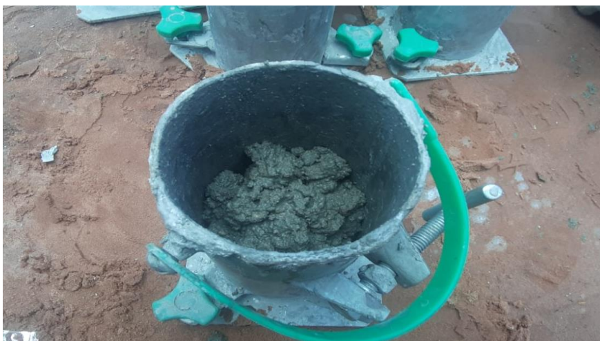
Figura 10: Corpo de Prova Concretado até a Metade
