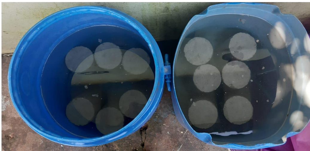
Figura 12: Corpo de Prova Submerso em Água
