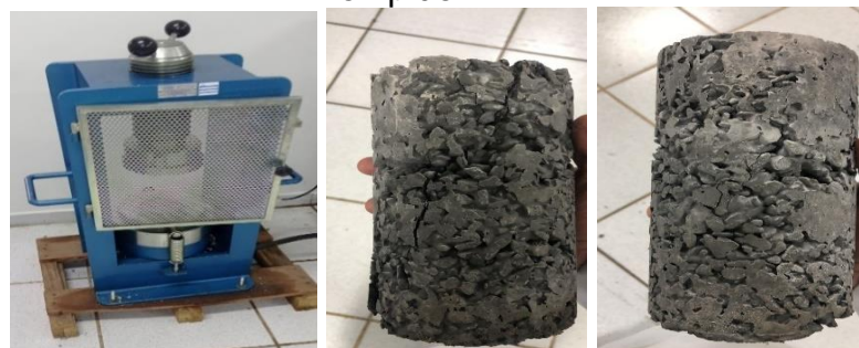
Figura 17: (a) Prensa hidráulica; (b) Corpo de prova Rompido; (c) Corpo de prova Rompido.
