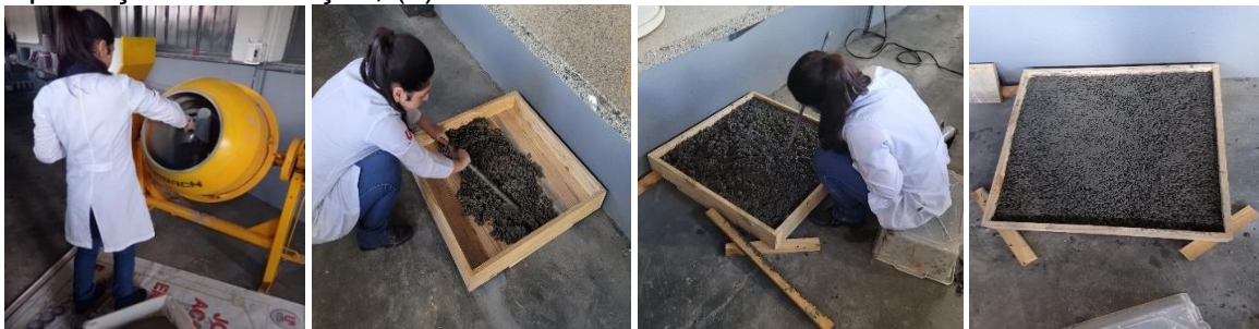
Figura 19: (a) Preparação do cimento; (b) Colocação e compactação; (c) Compactação e finalização; (d) Cura.
