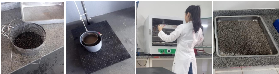
Figura 12: (a) Cesta metálica; (b) Pesagem da amostra imersa; (c) Secagem; (d) Amostra seca.
