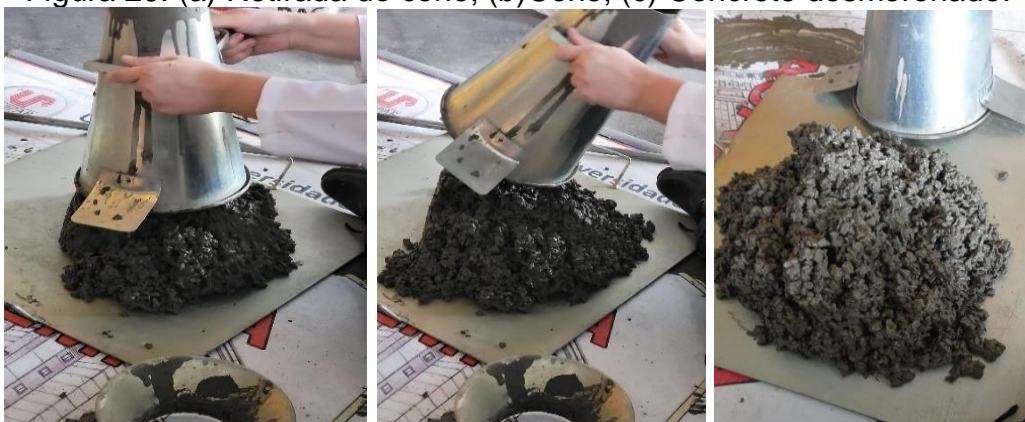
Figura 29: (a) Retirada do cone; (b) Cone; (c) Concreto desmoronado.
