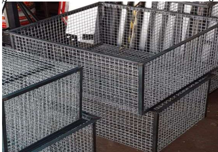
Figura 21: Cesto coletor confeccionado na metalúrgica.
